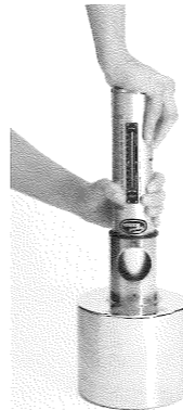
Fig. 3.1 Contrôle de fonctionnement du scléromètre à béton (modèles illustrés: N/L)
