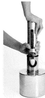
Fig. 3.1 Funktionskontrolle des Betonprüfhammers (Modell N/L abgebildet)
